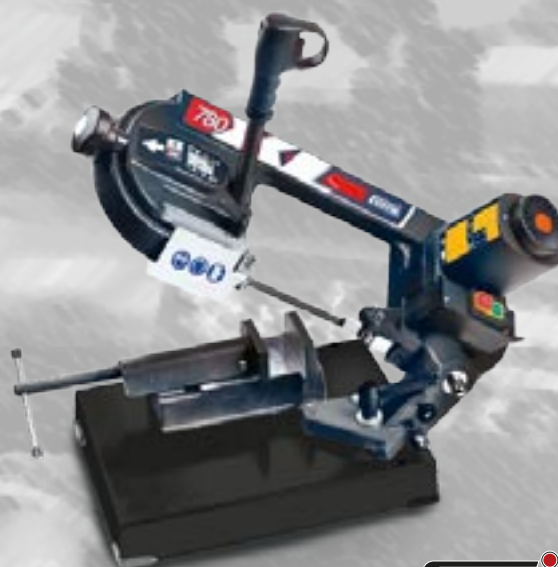
FM-780XL Ref. A025392 Medida cinta (mm/Ø):1.335x13x0,65 850 W- 2 Velocidades Sin lubricación
