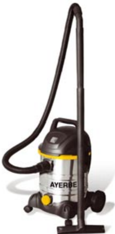
Ref. A019002 ASPIRADOR 1300 INOX AYERBE 1.300 W. BY-PASS 2 Etapas. 230 V. / 50 Hz. Aspirador para polvo y agua inoxidable. Capacidad depósito 20 l. Depresión 1600 mm. / agua. Caudal 170 m³/h. Peso: 6,8 kg. 88,40€
