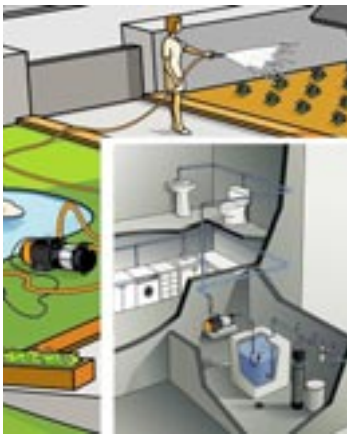
Ref. A053964 BOMBA DE SUPERFICIE MISTRAL 90 KIT 02 ESPA LEADER 750 W. Caudal máximo 6.600 l/h. Altura máxima 43 m. Incluye kit de instalación. 199,60€
