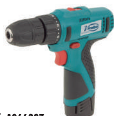
Ref. A066897 TALADRO ATORNILLADOR C/BATERÍA ATB40 VIRUTEX 12 V. 1,5 Ah Litio-Ion. Par de giro: 25/14 Nm. Velocidad en vacío: 0-400/0-1400/min. Portabrocas: 0,8-10 mm. Luz LED. Peso: 1 kg. Incluye: 2 baterías, cargador, punta doble y maletín.
