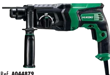
Ref. A044879 MARTILLO COMBINADO DH26PC2Z SDS-PLUS HIKOKI 830 W. Energía de impacto: 2,9 J. Capacidad en hormigón: 26 mm. Peso: 2,8 kg. SDS-PLUS.
