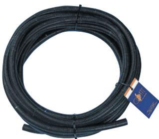
Disponible en dos formatos: el estándar fabricado en PVC con una resistencia a la compresión de 320N y resistencia al impacto de 1J. Y el tubo reforzado, fabricado en un material que no propaga la llama en caso de incendio y con una resistencia a la compresión de 230N y al impacto de 2J.
